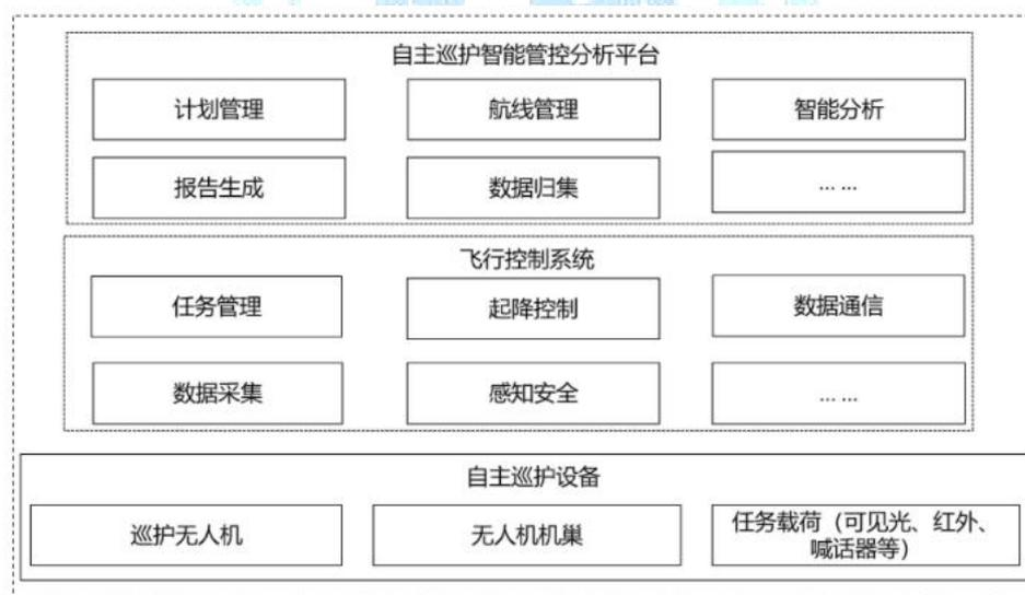
图 1 无人机林业自主巡护系统架构
